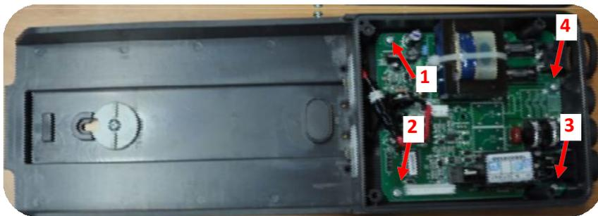
Remettre le branchement lié au fusible (1) puis ceux liés à la partie supérieure du boîtier de contrôle (2 + 3) :
