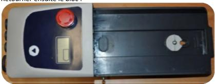
Tirer la partie supérieure vers le haut afin d'enlever un branchement. Puis la tourner sur le côté pour enfin débrancher le deuxième branchement de la partie supérieure, comme l'image ci-après : ETAPE N°2
